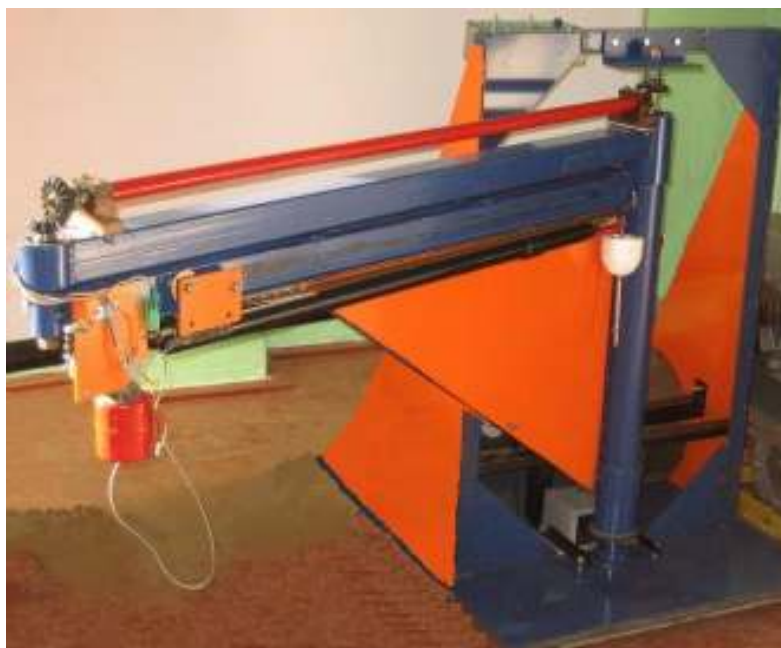
Рисунок 1. Физическая модель манипулятора для ввода отсечных элементов в ванну кислородного конвертера
